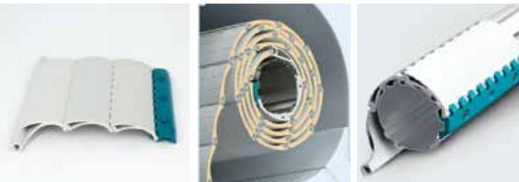
Dank des neuen Wellenverbinders ist das Wickelverhalten des Rollladenpanzers stark optimiert worden. So wickelt sich der Panzer in Zukunft deutlich runder und enger um die Welle. Durch eine engere Wicklung haben die Panzer kleinere Ballendurchmesser und benötigen kleinere Kästen. Auch hier kann somit ganz einfach und effektiv Platz gespart werden. Zudem sorgen kleinere Kästen in der Fassade für eine Erhöhung von Tageslicht im Inneren des Gebäudes.
