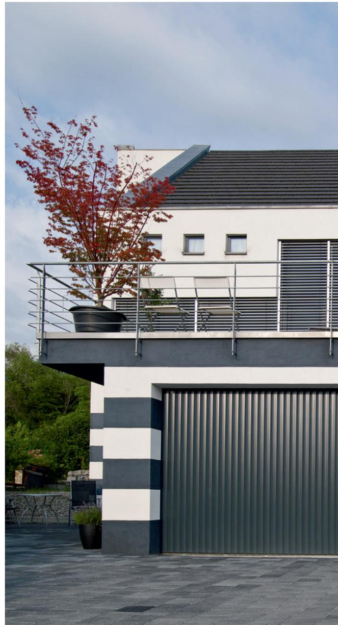
**Vertico** glänzt durch großen Spielraum bei den Einbaumöglichkeiten. Das System benötigt nur geringe 5 cm im Sturzbereich. Der seitliche Wenderadius ist mit 13 cm besonders klein. Seine Bauformvarianten von 75° und 105° geben zusätzliche Einsatzflexibilität.
